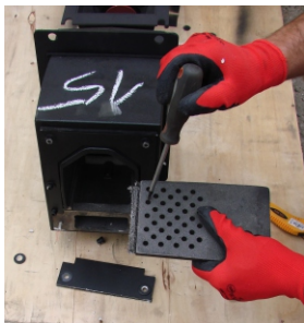
04. Oczyszć otwory napowietrzne oraz usuń popiół z komory powietrznej pod rusztem. Włóż ruszt paleniska, załóż płytkę wyczystną. dociśnij ruszt paleniska do dołu, aby równo leżał, dokręć.
