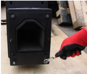
01. Odkręć kluczem „13” płytkę wyczystki
