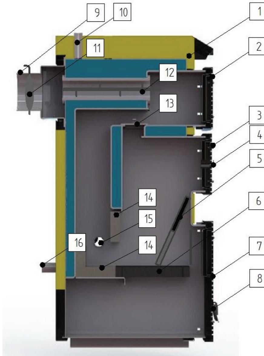
1- izolacja termiczna, 2- drzwiczki wyczystne, 3- drzwiczki obsługowe (zasypowe), 4- przepustnica drzwiczek środkowych, 5- płyta zsykowa, 6-ruszt paleniskowy 7- drzwiczki popielnikowe, 8- przepustnica drzwiczek dolnych, 9- czopuch, 10-króciec zasilania, 11- przepustnica czopucha, 12- zawirowywacz powietrza, 13- przepustnica skrótów spalin, 14- dysza ceramiczna, 15- przepustnica powietrza wtórnego, 16- króciec powrotu
