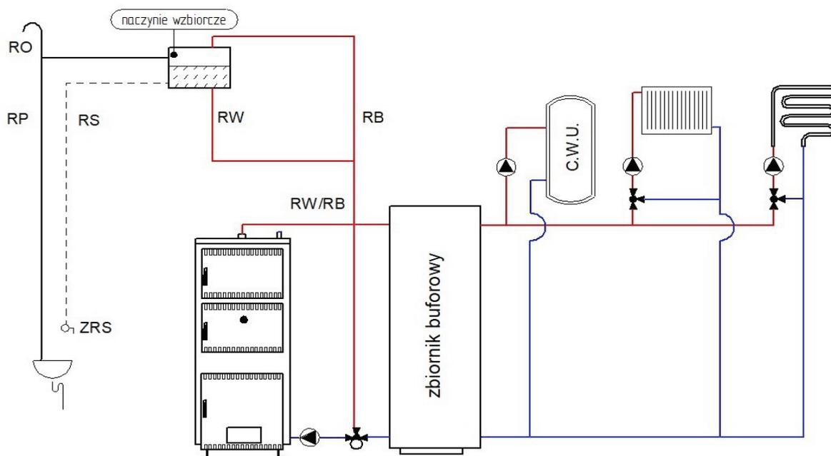
RO-rura odpowietrzająca RB-rura bezpieczeństwa RW-rura wzbiorcza
